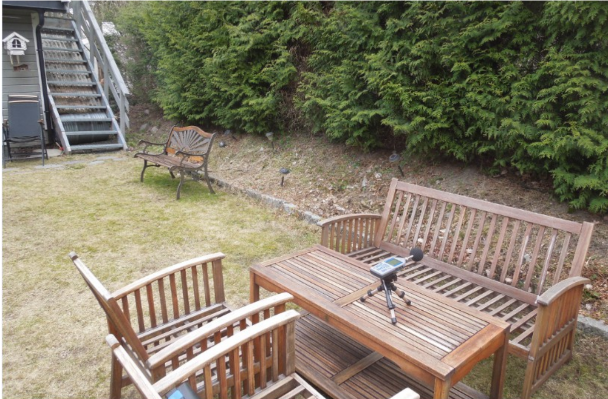
Uteplass, Veien 127. Tujahekk demper støyen med 2-3 dBA, men den ligger like fullt rundt 60 dBA eller i overkant.
